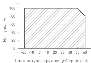
Рис. 3. Максимальная допустимая нагрузка, % от мощности источника
