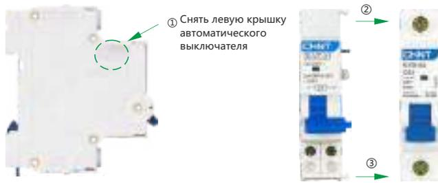
После сборки OUVT-X1 и автоматического выключателя установите их на стальную монтажную рейку TH3.5-7.5.
