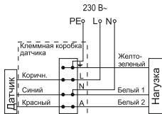
Рисунок 18 – Схема подключения датчиков ДД-017, ДД-019
