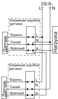
Рисунок 19 – Схема параллельного подключения датчиков
